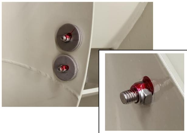
Bild: Prinzipdarstellung: Sicherung der Wuchtgewichte durch farblich erkennbaren Sieglack (Loctite SF 7400, oder SF 7240 Schraubensicherungslack)
