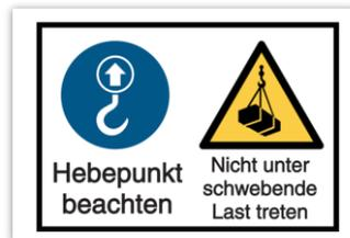
Hebeösen am Motor, Ösen am Gehäuse, an der Motorkonsole, oder eine Umschlingung des Ventilatorengehäuses eignen sich als Anschlagpunkte zum Heben des Ventilators. Auf keine Fall am Laufrad anheben oder abstützen.
