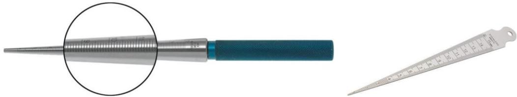
Werkzeug zur Spaltmessung: Bohrungslehre oder konischer Messkeil; Aufgrund von Fertigungsungenauigkeiten wird der Spalt umlaufend nicht gleich sein können. Es darf an keiner Stelle zu einem Kontakt zwischen dem rotierenden Laufrad und der feststehenden Einströmdüse kommen.
