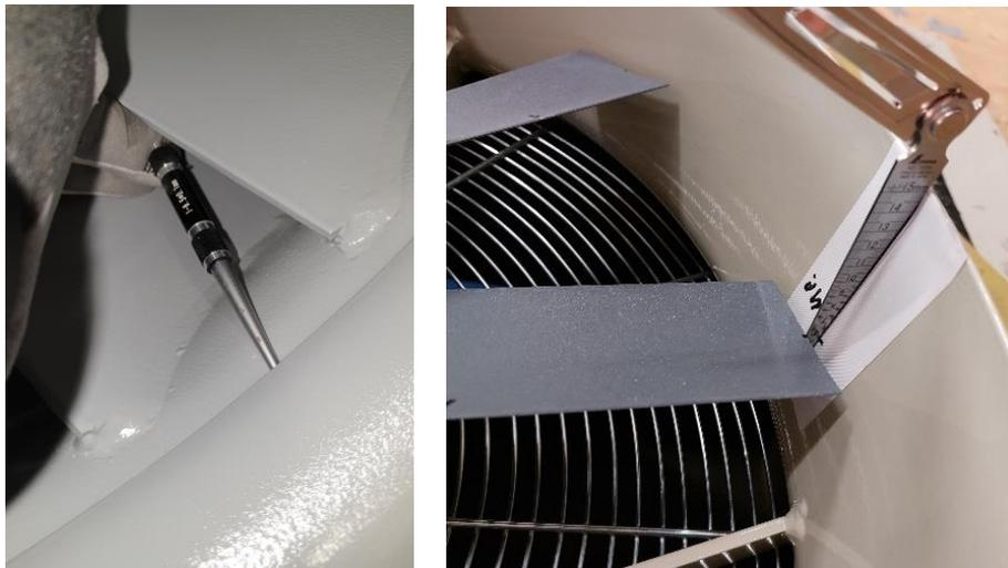
Beispiel für Spaltprüfung zwischen Einströmdüse und Radial-Laufrad (links) bzw. zwischen Gehäusewand und Schaufelspitze (rechts)
