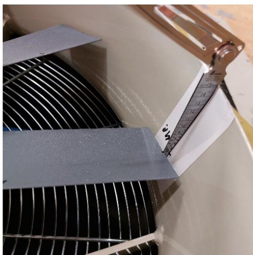
*Beispiel für Spaltprüfung zwischen Einströmdüse und Radial-Laufrad (links) bzw. zwischen Gehäusewand und Schaufelspitze eines Axiallaufrads (rechts)*
