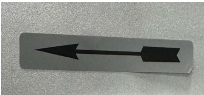
Exemple illustré de flèche de sens de rotation
