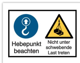
Hebeösen am Motor, Ösen am Gehäuse, an der Motorkonsole, oder eine Umschlingung des Ventilatorengehäuses eignen sich als Anschlagpunkte zum Heben des Ventilators.
